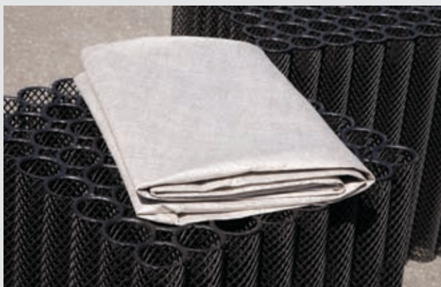
En BIO-BLOK® modul består av nättrådar producerade av miljövänlig polyeten som endast med hjälp av värme sammansvetsats till en kub. Genom att packa in modulerna i fiberduk (klass N1) utestängs jord, sand och andra partiklar från dagvattensystemet.
