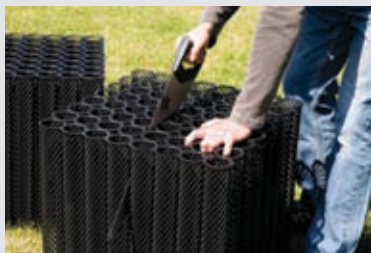
1: Placera ut BIO-BLOK® modulerna på marken. Märk ut och påbörja utgrävningen för anslutningsrör och dagvattensystem. Var uppmärksam på att frostsäkert djup ligger på från 75 cm. Anslutningsrörets fall 1 cm/m. Gräv 10-15 cm bredare och längre än den yta systemet upptar.
